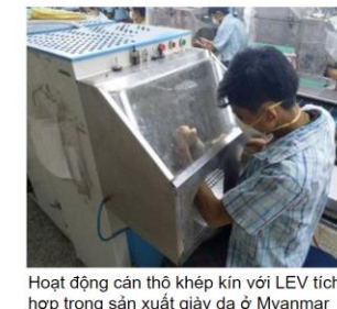
Máy hút mùi LEV để loại bỏ hơi hóa chất trong thời gian thùng đựng hóa chất đang mở
