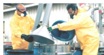
Máy hút mùi LEV để loại bỏ hơi hóa chất trong thời gian thùng đựng hóa chất đang mở
