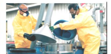
Máy hút mùi LEV để loại bỏ hơi hóa chất trong thời gian thùng đựng hóa chất đang mở
