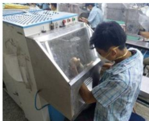
Hoạt động cabin khép kín với LEV tích hợp trong sản xuất giấy da ở Myanmar
